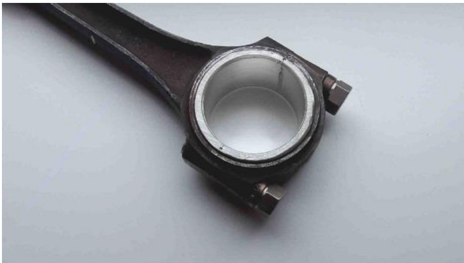
Neu gegossene Lagerschale; vorgedreht
